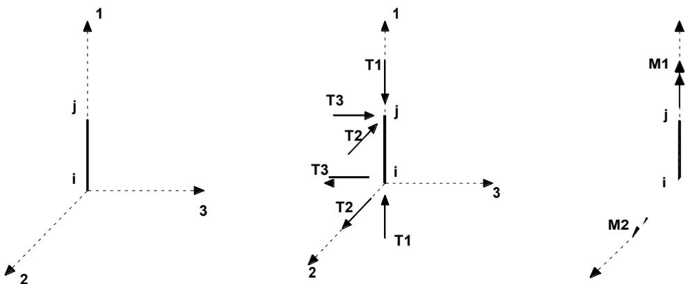
Definiti i e j come i due nodi iniziale e finale del pilastro, viene individuato un sistema di assi cartesiani 1-2-3 locale all'elemento, con origine nel Nodo i così composto:
